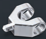
36 × 44 × 10 mm Trykstang Fræsning HSC 70 linear Materiale: Aluminium Funktionstid: 28 min.
