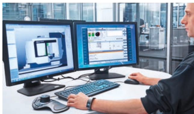
DMG MORI Virtual Machine er et 1:1-billede af DMC 160 H duoBLOCK® inkl. den faktiske styring.
