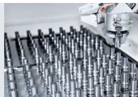
Takket være integreret automatisering fremstiller M.T. batchstørrelser på op til 1.500 dele næsten uden bemanding.
