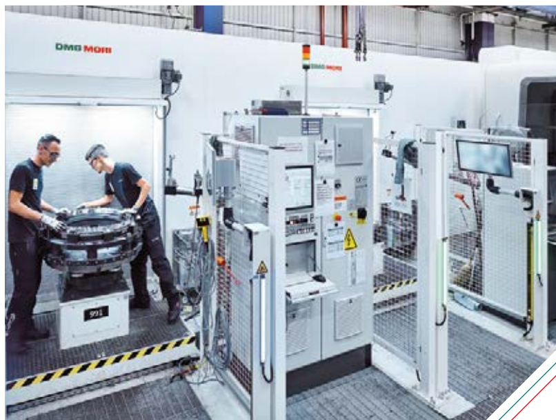
Klargøringsplads til produktionlinjen med de fire DMU 80 FD duoBLOCK-maskiner.
