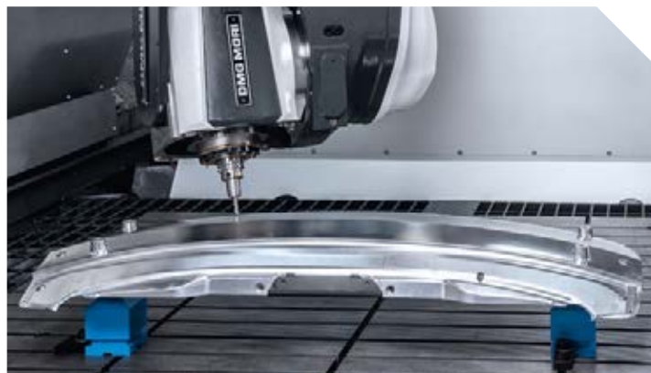
Die & Mold: 5-akset simultanbearbejdning af en formindsat i aluminium.
