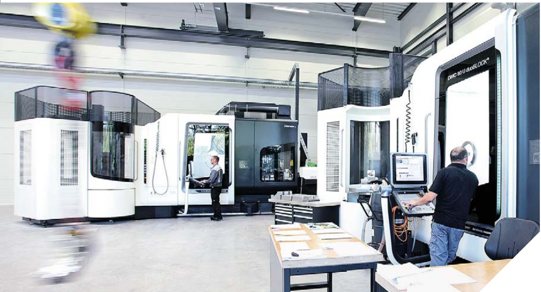
De to DMC 80 U duoBLOCK-maskiner, der er forsynet med den roterende opbevaring RPS 12 med plads til op til 12 paller, kan arbejde effektivt døgnet rundt.
