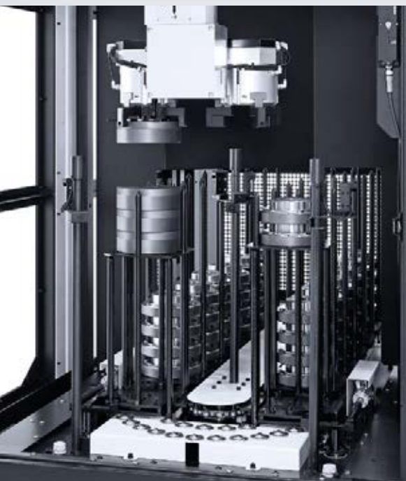
Stabelmagasin med op til 20 pallepladser med maks. 75 kg og op til 26 til maks. 35 kg belastning pr. plads.
