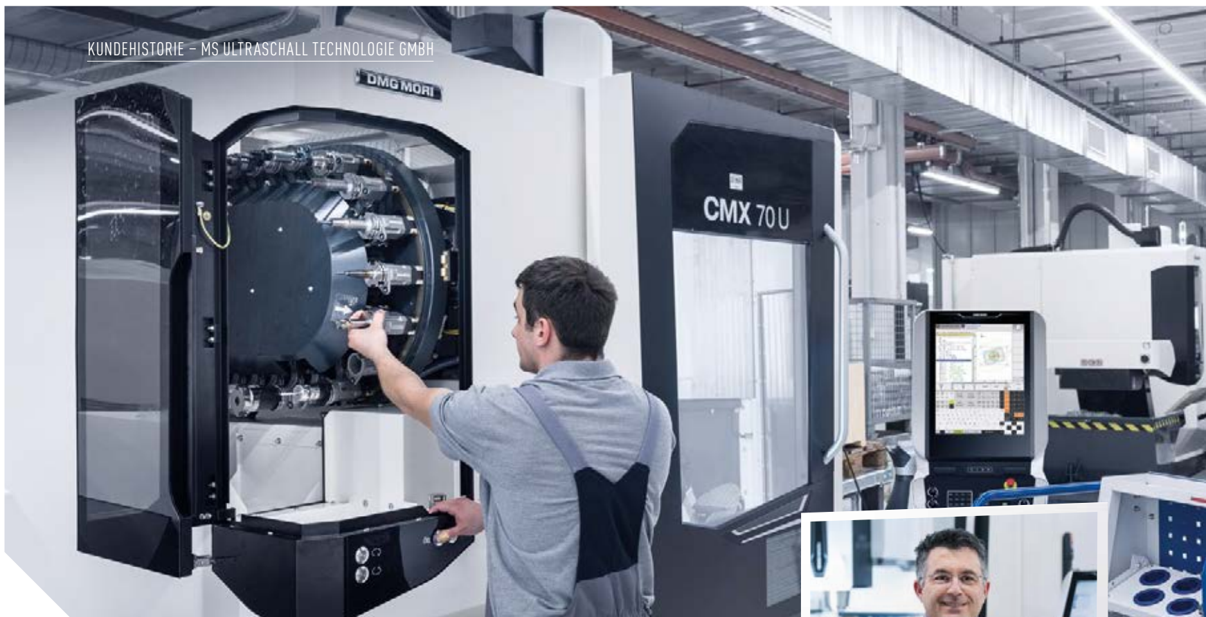
Klargøring under driften takket være et værktøjsmagasin på en CMX 70 U, der kan tilgås separat.
