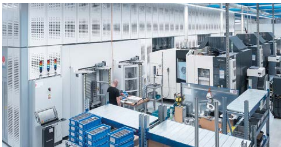
Det største af de automatiseringsanlæg, der er blevet installeret indtil nu, omfatter tre DMC 60 H-maskiner, der alle har et 5-dobbelt hjulmagasin til 303 værktøjer.
